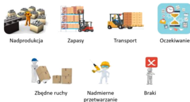
Rys. 1. MUDA-7 głównych źródeł marnotrawstwa w procesach produkcyjnych.
